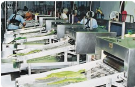
Slika 8: Iztiskanje soka med valji
