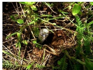
Slika 4: Merjenje temperature zemlje (globina 15 cm) (VIR: Maja Levak)
