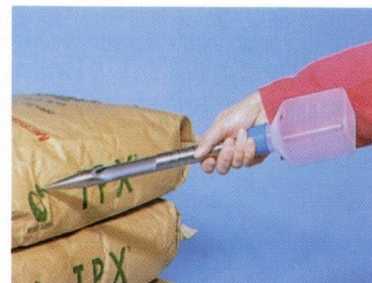
1. Sondo potisnemo v vrečo do željene globine.
