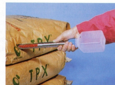
2. Izvlečemo jo z vzorcem, ki je napolnil polkrožno odprtino v sondi.
