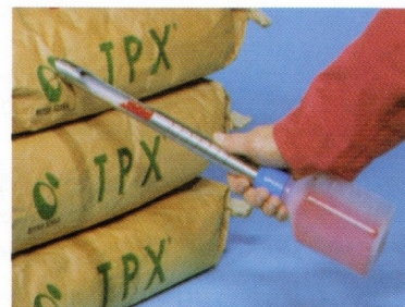
3. Nagnemo sondo, tako da vzorec pade v vzorčno posodo.
