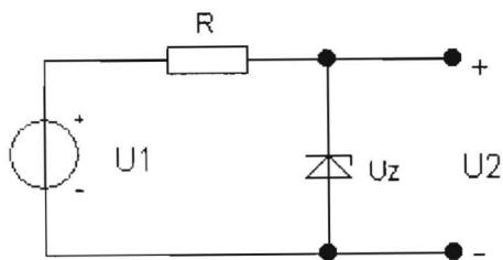
12. Določi izhodno napetost  $U_2$  in največjo moč na stabilizatorju, če je  $U_{1\max} = 18V$  in  $R_b = (20 \dots \infty) \Omega$ !
