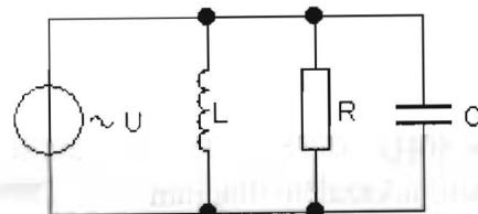
$U = 20\text{V}$ ,  $I_L = 5\text{mA}$ ,  $I_R = 1\text{mA}$ ,  $I_C = 3\text{mA}$ . Nariši kazalčni diagram tokov, izračunaj skupni tok in kot med tokom in napetostjo! Določi upornosti in prevodnosti posameznih elementov in polno upornost ter prevodnost vezave!
