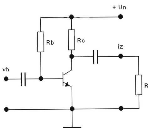
Nariši poenostavljeno nadomestno vezje bipolarnega tranzistorja, dodaj upore iz vezja in izračunaj  $A_u$ ,  $R_v$  in  $R_i$  ojačevalnika, če je  $\beta = 150$ ,  $R_c = R = 1,2 \text{ k}\Omega$ ,  $R_b = 100 \text{ k}\Omega$ ,  $h_{ie} = 1 \text{ k}\Omega$
