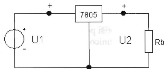
13. Določi hladilno telo ( $R_{th}$ ) za tritočkovni stabilizator iz vezja, če je:  $R_{jc}=5 \text{ K/W}$ ,  $T_{jmax}=150^\circ\text{C}$  in temperatURA okolice  $T_a = 40^\circ\text{C}$ !
