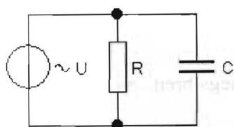
$U = 5\text{V}$ ,  $R = 1\text{k}\Omega$ ,  $f = 10\text{kHz}$ . Izračunaj  $C$ , tako da bo  $X_C$  po velikosti enaka  $R$ . Za ta primer nariši kazalčni diagram in trikotnik tokov ter prevodnosti. Izračunaj vse tri tokove in kot med  $I_R$  in  $I$ .
