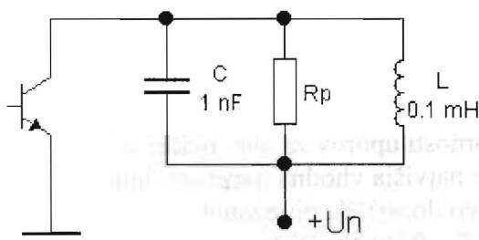
Upornost  $R_p = 10 \text{ k}\Omega$  združuje izgubno upornost nihajnega kroga in izhodno upornost tranzistorja. Izračunaj resonančno frekvenco in pasovno širino selektivnega ojačevalnika. Skiciraj njegovo frekvenčno karakteristiko in označi značilne vrednosti ( $f_r$ ,  $f_s$ ,  $f_z$ ,  $A_0$ ).
