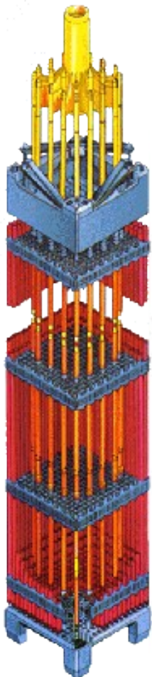
Slika 2: Gorivni sveženj z regulacijskimi palicami
