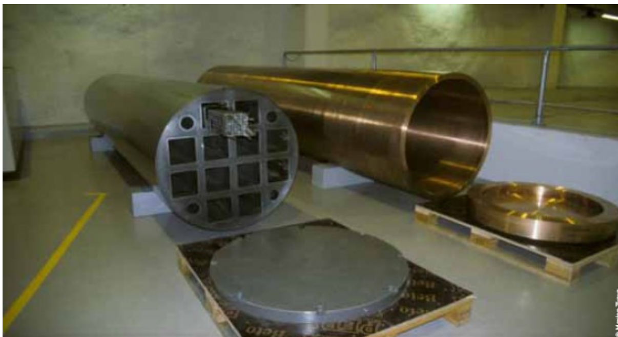
Slika 48: Vsebnik za izrabljene gorivne elemente. Zunanji del je iz bakra.
