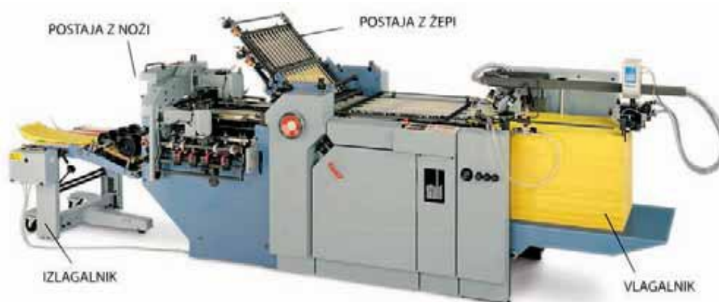
Kombinirani zgibalni stroj z noži in žepi
