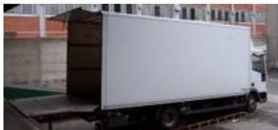
Autocarro furgonato e sponda montacarichi posteriore
