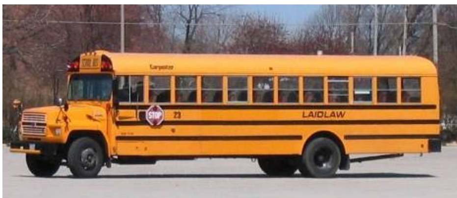
Slika 11 Šolski avtobus, pobarvan z rumeno barvo, ki vsebuje kromove in kadmijeve pigmente
