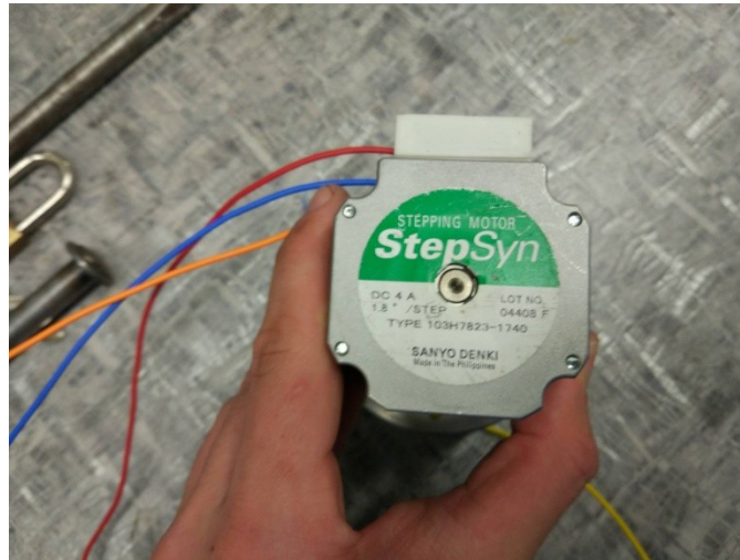
Slika 29: Zadnji del koračnega elektromotorja s specifikacijami (osebni vir)
