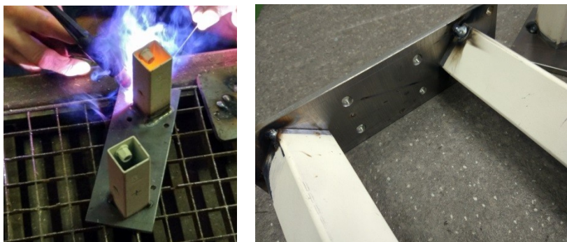
Slika 18: Varjenje plošče na profile (osebni vir)
