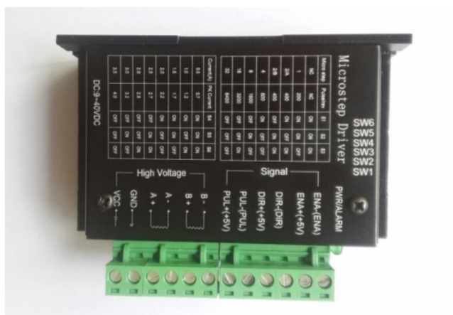
Slika 40: Gonilnik za koračne motorje (osebni vir)
