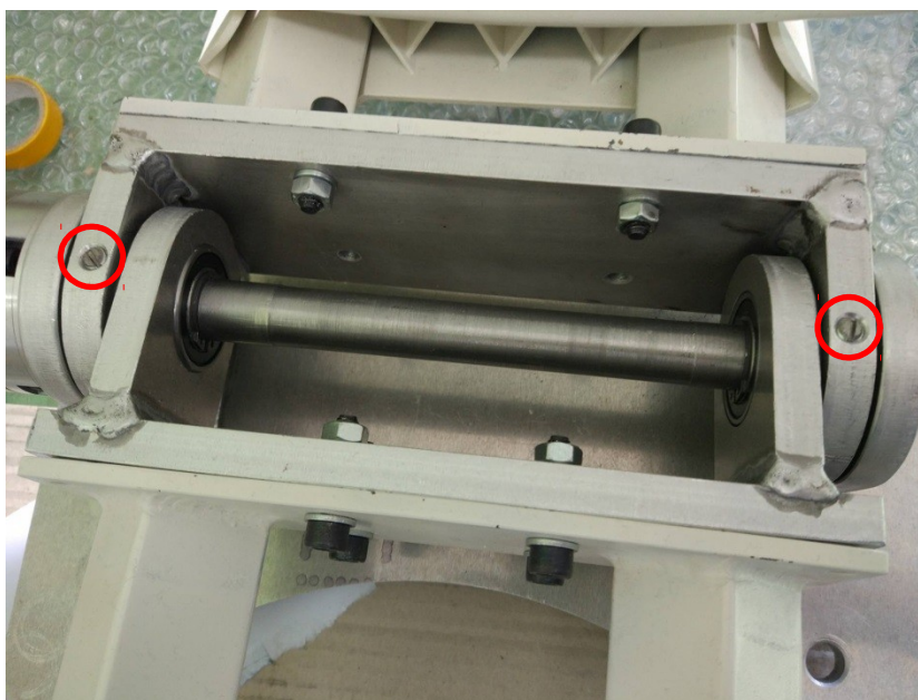
Slika 21: Pregibni sklop s strojnimi vijaki (osebni vir)
