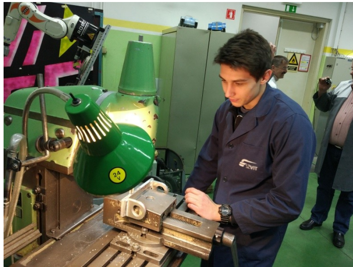
Slika 16: Frezanje robov pregibnega elementa (osebni vir)
