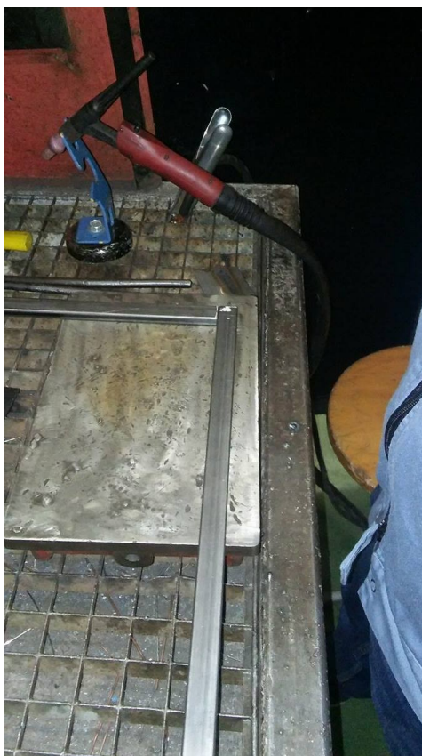
Slika 2: Varjenje ogrodja z tigom
