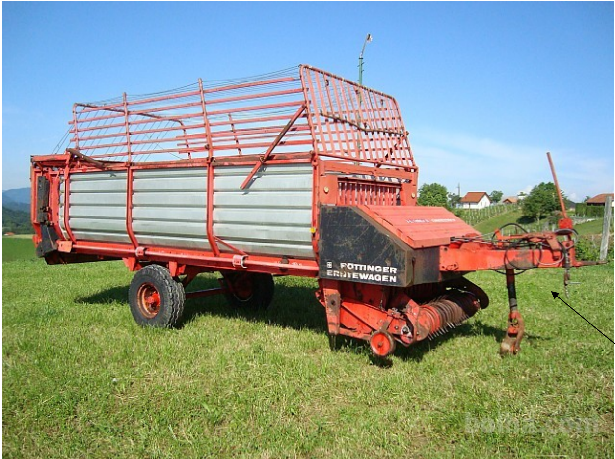
puščica prikazuje visoko vpetje na priključku.
