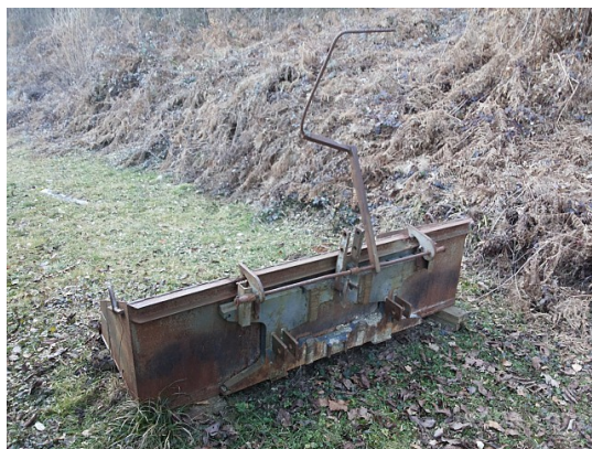
slika 1: preprost starejši prekucni plato na ročno opravljanje
