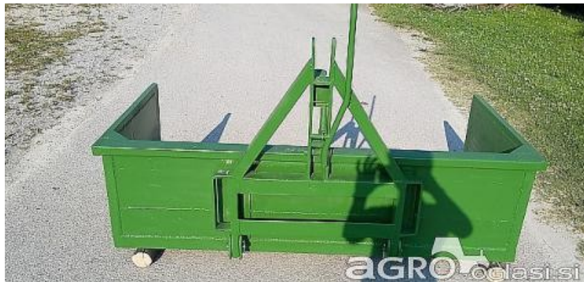
Slika 2: 1 Pregibni plato z ročnim upravljanjem
