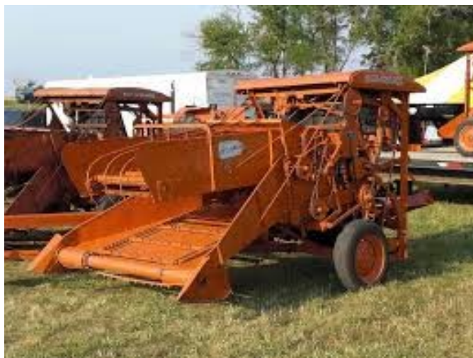
Slika 1: Stiskalnica za valjaste bale Allis Chalmers Roto Baler (2002)
