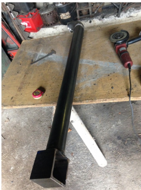
Slika 14: Pritrjena vilica na kvadratni pomični del
