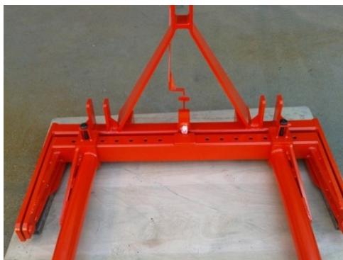
Slika 4: Prekucne in pomične vile za bale
