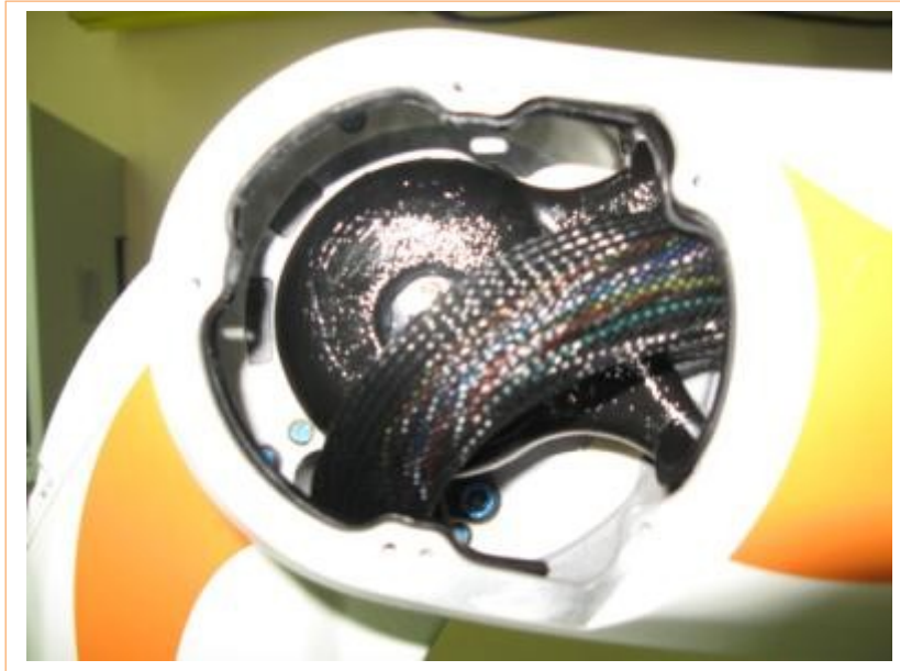
Slika 8.27: Servopogon robota s harmonskim gonilom
