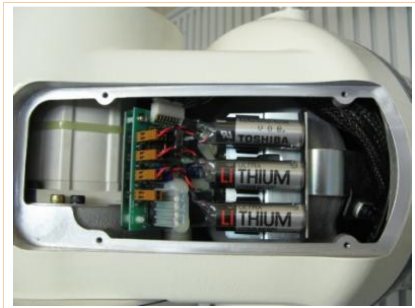
Slika 8.24: Baterije v namen ohranitve položaja v primeru izpada električne energije
