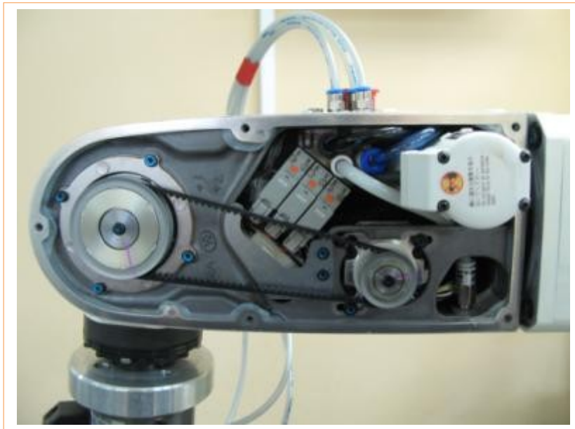
Slika 8.28: Servopogon robota z zobatim jermenom
