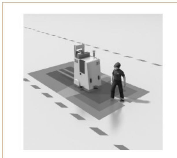
Slika 13.16: Varovanje vozila z več območji v obeh smereh vožnje
