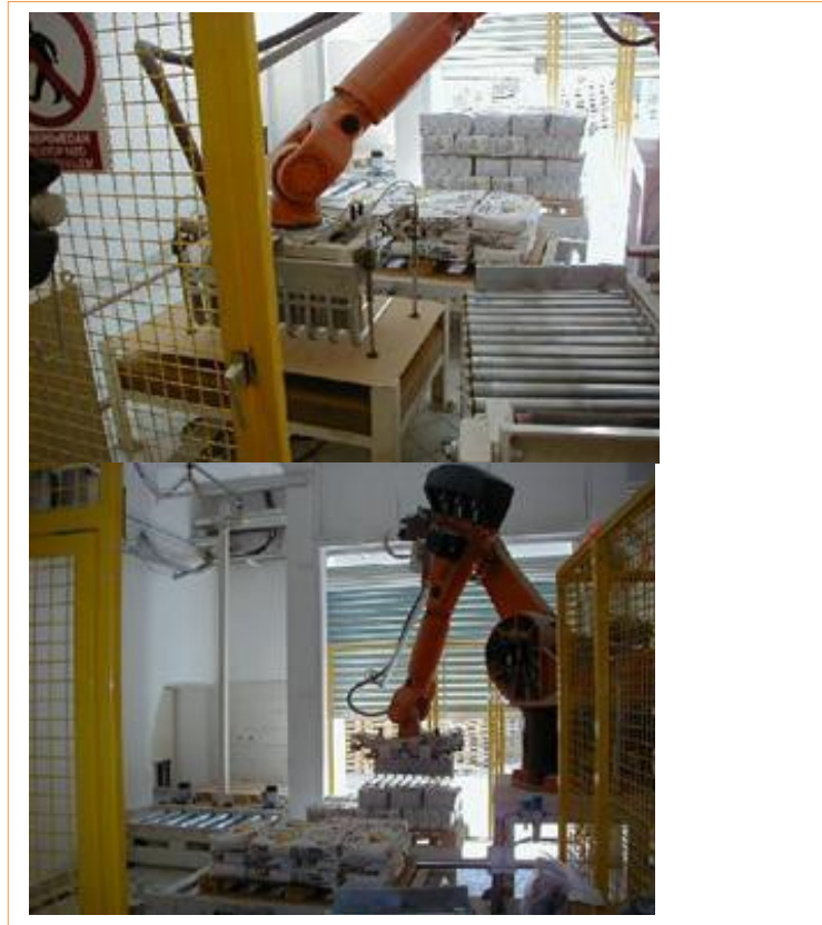
Slika 7.5: Avtomatizirano zlaganje vreč na palete v JUB-u (Pakman)
