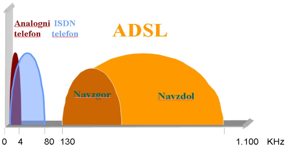
Iz te slike lahko razberemo na katerih frekvenčnih območjih delujejo analogna telefonija, ISDN telefonija ter seveda ADSL. Vidimo, da se POTS in ISDN prekrivata kajti ISDN ne nadgraditev analognega telefona. Kot vidimo, ISDN zavzame kar precej več pasovne širine kot POTS. Zraven obeh je pa ADSL. Kot vidimo, ADSL izrablja popolnoma ne izrabljen del bakrene parice. Zato je teoretično možno, da imamo z analognim telefonom večjo pasovno širino za internet, kot pa z ISDNjem.
