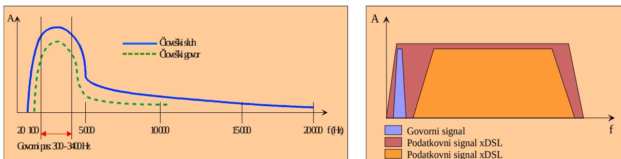
Na teh dveh slikah je prikazan način delovanja xDSL tehnologij. Na levi sliki vidimo uporabo samo analognega telefona, na desni je pa prikazana implementacija xDSL tehnologij.
