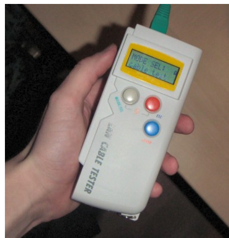
Slika 10: Naprava za testiranje kvalitete kablov (© Jan Marjanovič)
