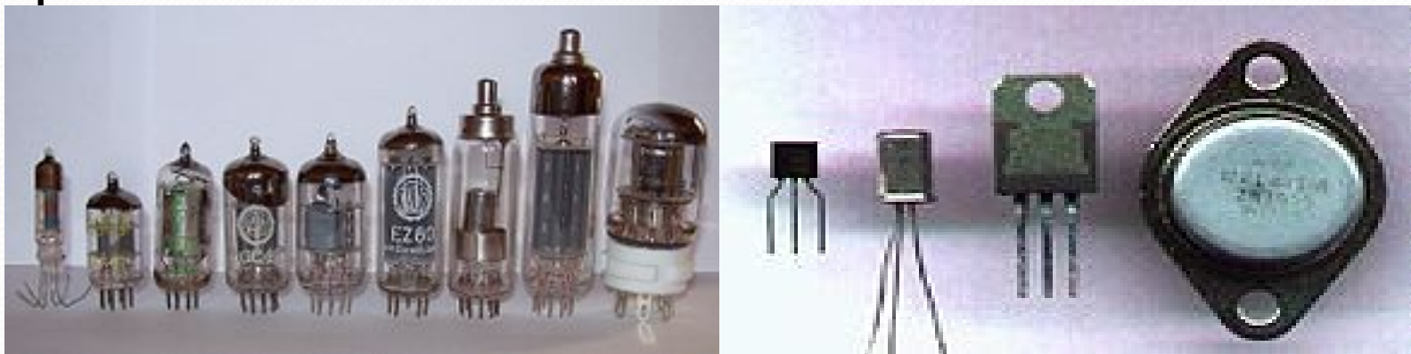
Primerjava elektronk in tranzistorjev
