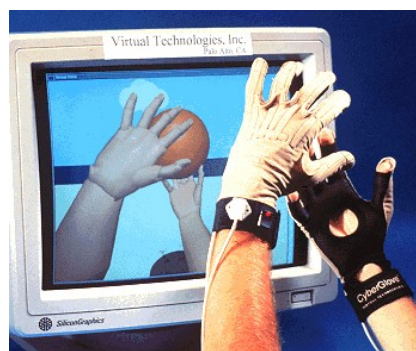
Slika 5: rokavice s senzorji gibanja
