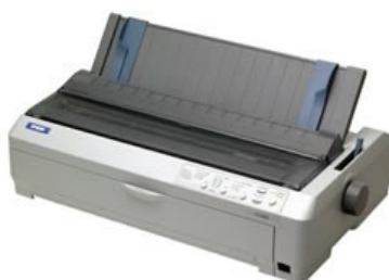
Slika 6: Primer igličnega ali matričnega tiskalnika
