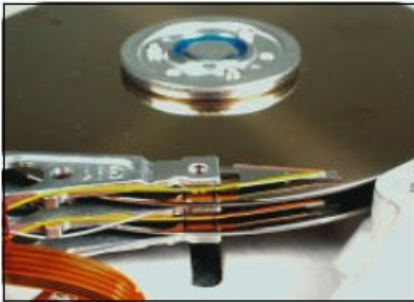
Slika 1: Plošče z bralno/pisalnimi glavami
