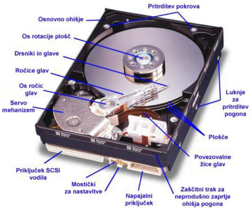
Slika 1: Zgradba trdega diska
