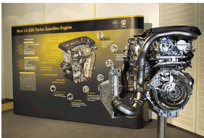
Slika 7: 1,6 litrski OPLOV motor, ki naj bi imel manjšo porabo in prostornino, večjo zmogljivost motorja ter manjše izpuste CO 2
