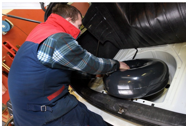
Slika 58: Posoda za gorivo se vgradi na mesto za rezervno kolo, indikator nivoja plina pa v potniško kabino. Sistem je nameščen na sesalnem delu motorja.
