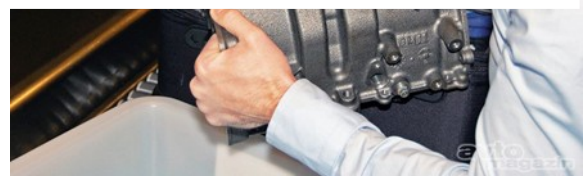
Slika 8: Fordov enolitrski EcoBoost, za 30 kg lažji od dosedanjega 1,6 litrskega štirivaljnega motorja
