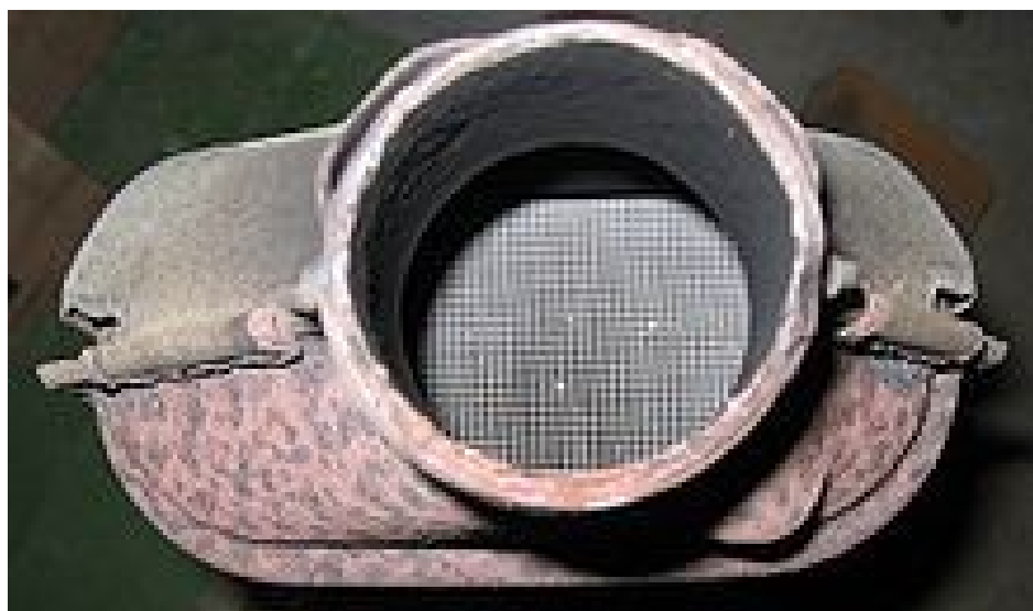
Slika 2 Keramično jedro katalizatorja
