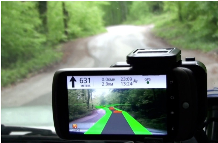
Slika 6 Aplikacija Wikitude Drive ki deluje na pametnih telefonih z operacijskim sistemom Android omogoča preko vgrajene kamere realen pogled na cesto pred vozilom
