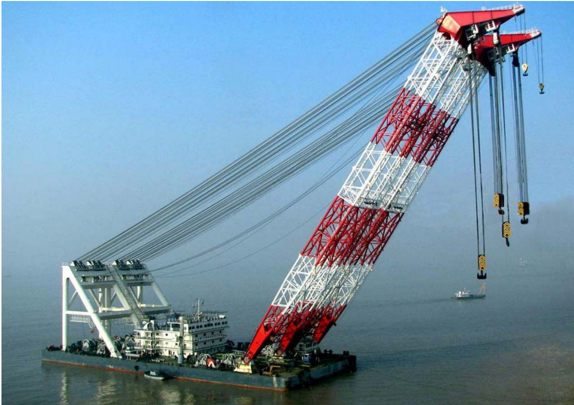
Slika 27:plavajoči žerjav z visoko nosilnostjo
