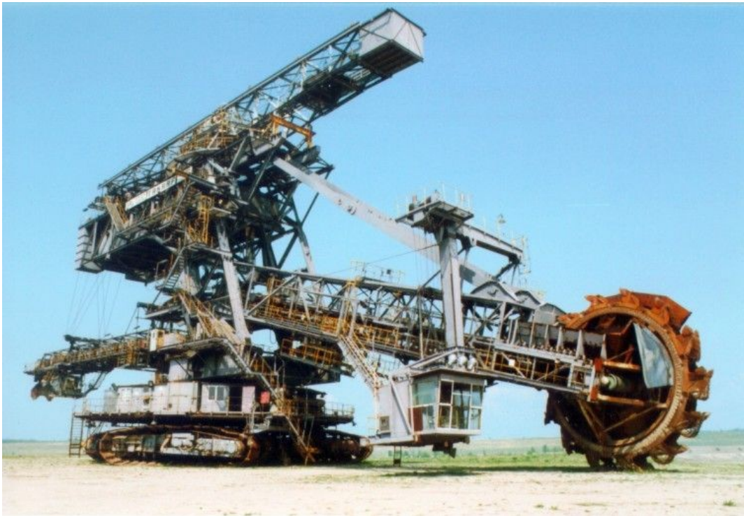
Slika 21: bager za površinsko kopanje rudnikov
