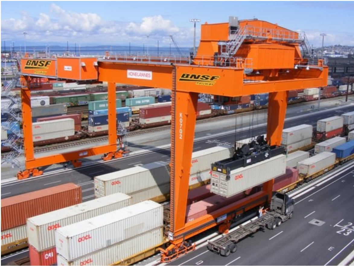
Slika 43: portalni prenosnik na tirih
