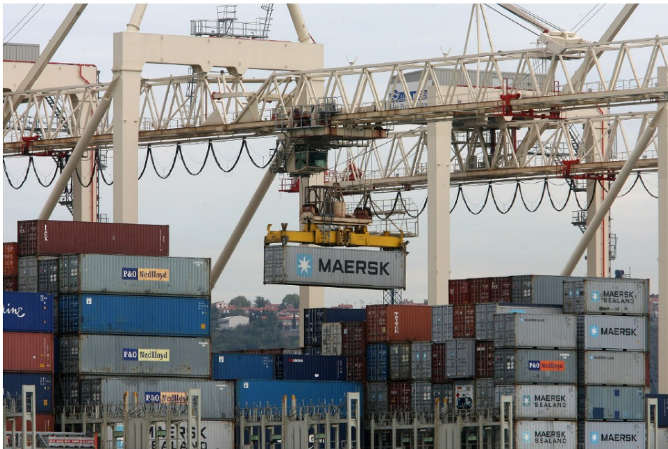
Slika 1: dvigalo v luki, kombinirano vertikalno in horizontalno
