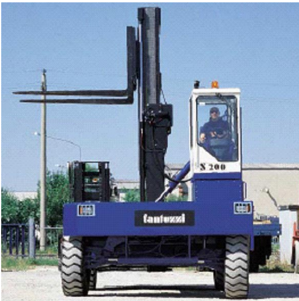
Slika 12: viličar s stranskim nakladanjem
