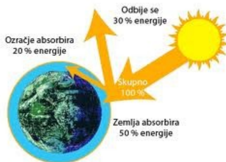
SLIKA 6: ODBIJANJE IN ABSORPCIJA SONČNE SVETLOBE, VIR: FOTOVOLTAIKA IN SONČNE ELEKTRARNE V SLOVENIJI (ONLINE)
