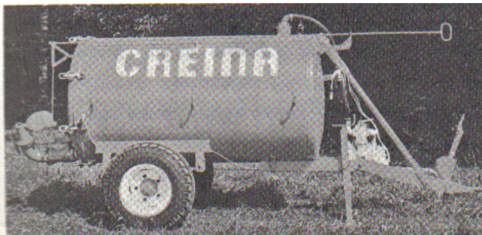
3. Slika: Sod z kompresorjem.
