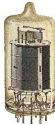
Slika 2: Vakumska elektronka z Eniaca
